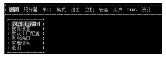
选择[保存当前设置]可实现参数的保存。保存成功后,再选择[重启设备]实现串口联网服务器的重新启动,使设置的参数生效。
