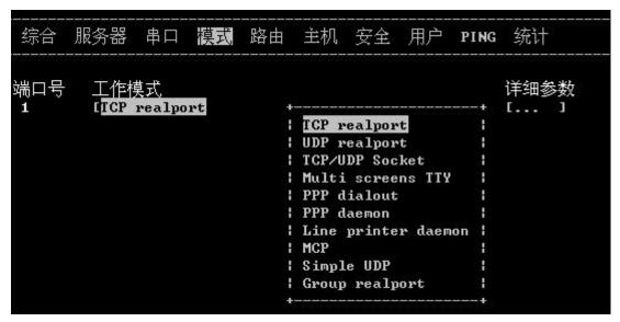
设置串口工作参数,将光标移动到[串口]并回车。根据所要连接的串口设备的波特率,数据位,停止位,校验位,流量控制,类型等设置串口联网服务器的相应端口参数。
