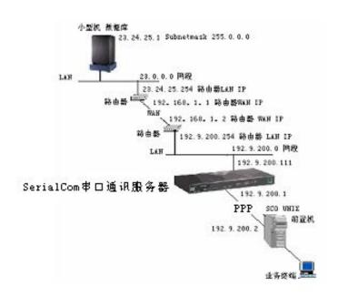
这个例子的特点是前置机配置的 PPP 链的 IP 地址与终端服务器设在了一个网段,此例中串口联网服务器的端口模式应做如下设置:
