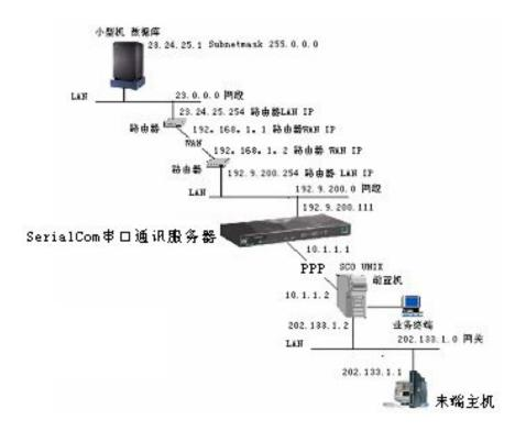
这个例子的特点是前置机配置的 PPP 链的 IP 地址与终端服务器设在了不同网段, 此例中串口联网服务器的 PPP daemon 的详细参数应做如下设置:
